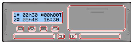
тахограф также называется «Автомобильное устройство (АУ)». Помимотахограф, автомобиль оснащается датчиком движения, который подключается к автомобилю и Тахограф. Дополнительную информацию о датчике движения и его подключении к автомобилю см. в пунктах **Датчик движения** на стр. 11 и **Подключение к приборной панели** на стр. 12.
